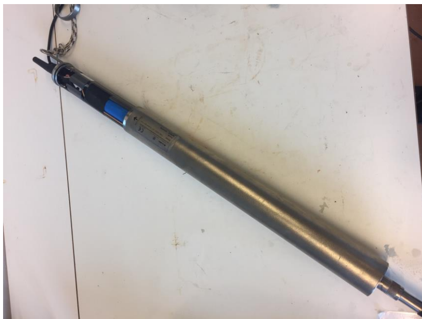
Figur 2. Exempel på telemetrienheter. TUBE300R från InSitu, delvis isärtagen.
