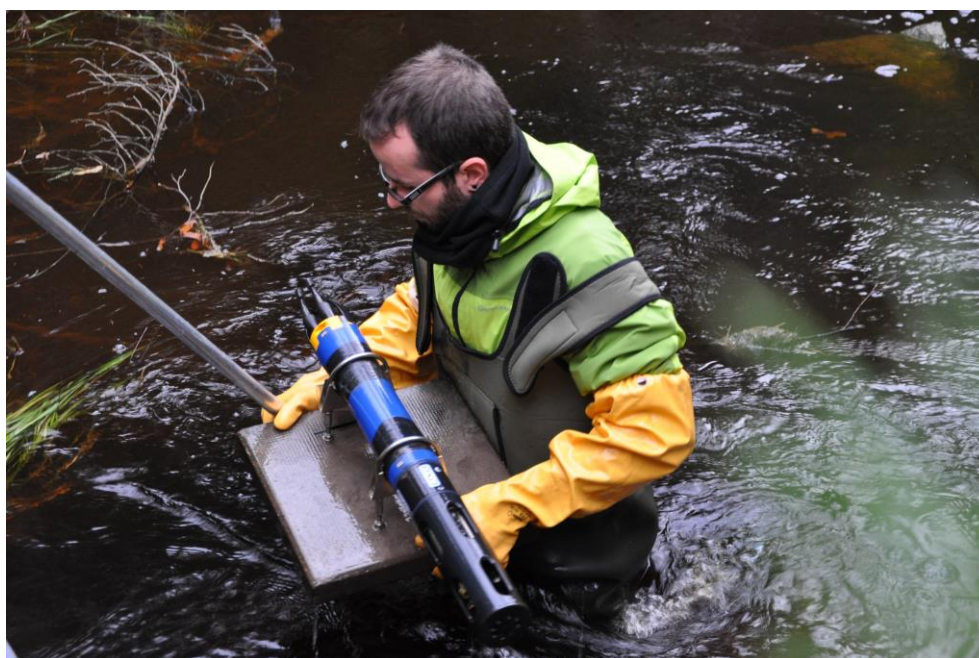
Figur 9. Sond installerad på cementplatta i Myckelmossbäcken.
