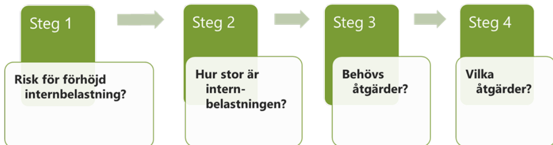
Figur 2. Schematisk bild över beslutverktygets fyra steg. I det första steget görs en bedömning om sjön ligger i riskzonen för en förhöjd internbelastning och i det andra steget mäts storleken på internbelastningen. Utifrån resultatet i steg 1 och 2 bedöms det om åtgärder behöver sättas in (steg 3) och i så fall vilka åtgärder (steg 4). Alla steg är nödvändiga för att inte riskera att onödiga åtgärder sätts in eller att effekterna blir begränsade och kortvariga.
