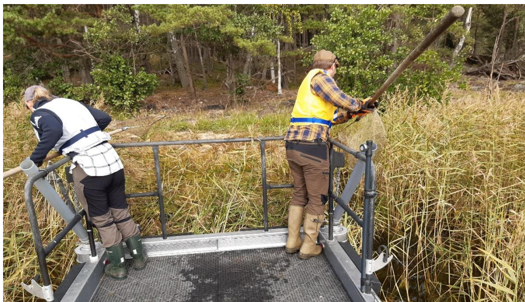
Figur 5. Foto illustrerar båtelfiske vid körning in i vassbälte med VFK-metoden. Vid elfisket användes en pulsfrekvens på 120 hertz och utgående spänning 500 volt vid 152 lokaler och 1000 volt vid 20 lokaler. Varje sträcka fiskades med ett strömpåslag på mellan 150 och 700 sekunder. Tiden och sträckans längd (54-548 m) varierade med anledning av habitatets utseende (homogenitet) men främst av tillgången av fisk. I områden med lite fisk hann man således normalt färdas en
